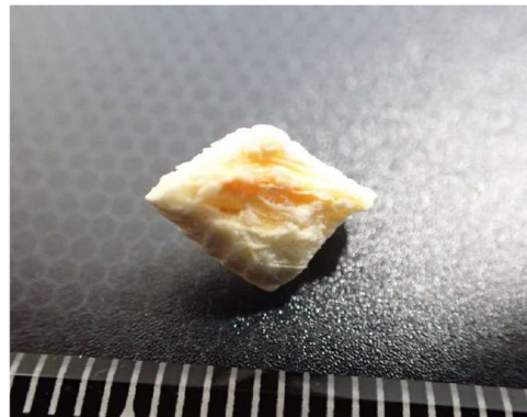
図2 オレンジ色の付着物が付いていた面 （異物下面）
